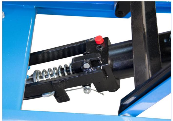
Détail de pompe, valve de sureté, cable de descente
