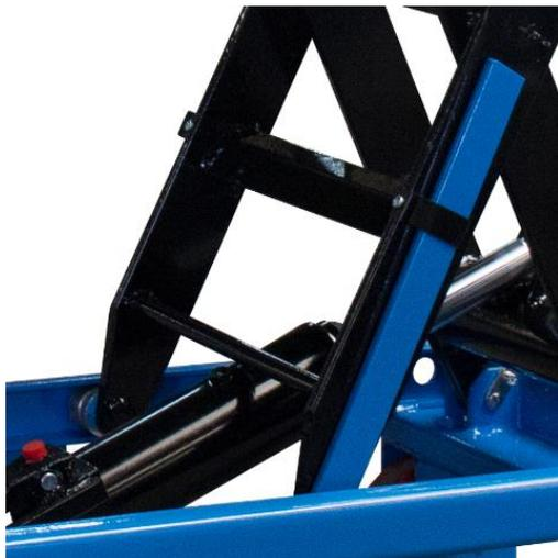
Détail pompe et système de sécurité de anti descente par tige
