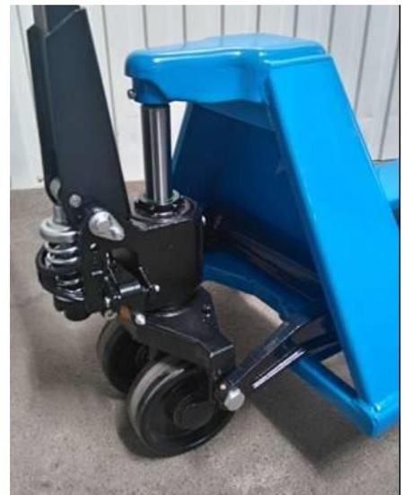
**Vue de dessous et vue arrière pompe et roues PU**
