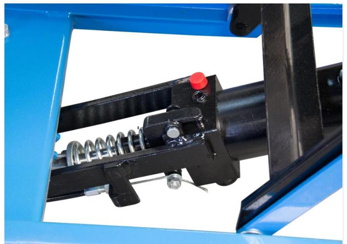
Détail pompe et système de sécurité de descente par tige
