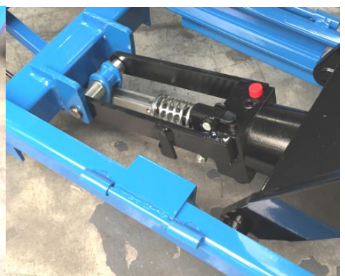
Détail pompe et système de sécurité de descente par coins
