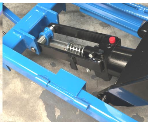
Detail pompe et système de sécurité de descente par coins
