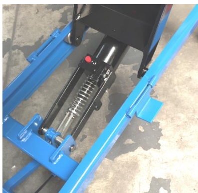
Detail pompe et système de sécurité de descente par coins
